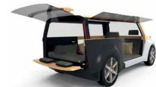
„WoodC.A.R.“ - Zeitalter Bioökonomie: Holz trifft Fahrzeugtechnologie - Holz ist ein Leichtbaumaterial mit hervorragenden Festigkeits- und Steifigkeitswerten sowie einem exzellenten Dämpfungsverhalten. Foto: ©WoodC.A.R.
